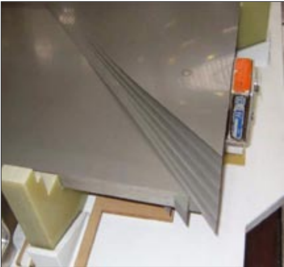
Rys. 4. Zaplatanie rdzenia według systemem step lap
