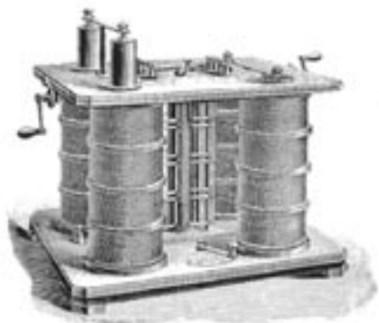
Rys. 3. Pierwszy wtórny generator zbudowany przez Gaularda i Gibbsa; po lewej stronie są widoczne dwie ruchome kolumny rdzenia częściowo wyciągnięte
