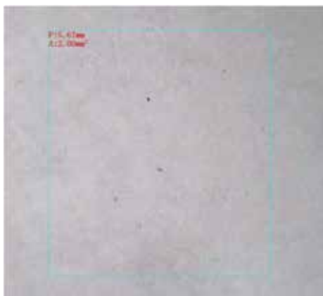
Zdjęcie 12. Zanieczyszczenia oleju świeżego
