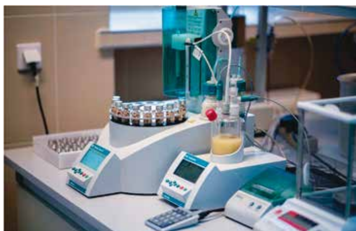
Zdjęcie 9. Aparat Coulometr 899 do oznaczania zawartości wody
