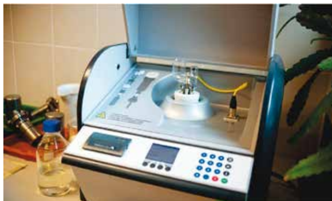
Zdjęcie 4. Aparat DTL C do pomiaru współczynnika strat
