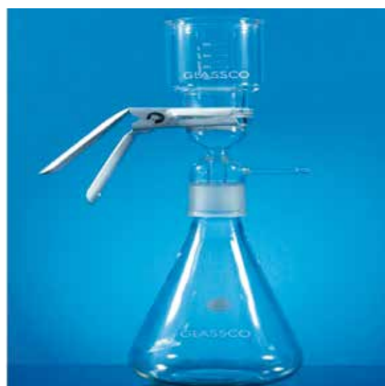
Zdjęcie 10. Zestaw do filtracji pod ciśnieniem
