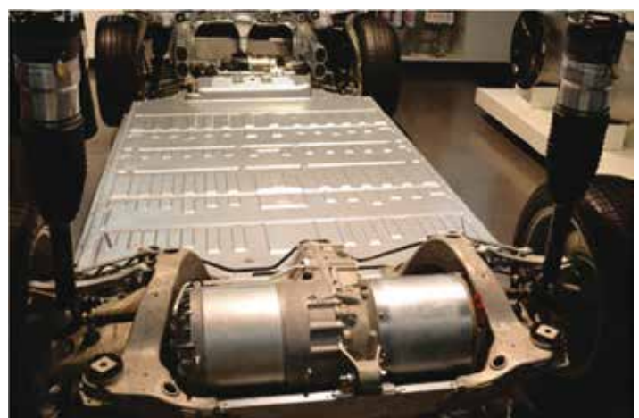
Rys. 4. Pakiet akumulatorów zintegrowany z zawieszeniem w samochodzie Tesla
