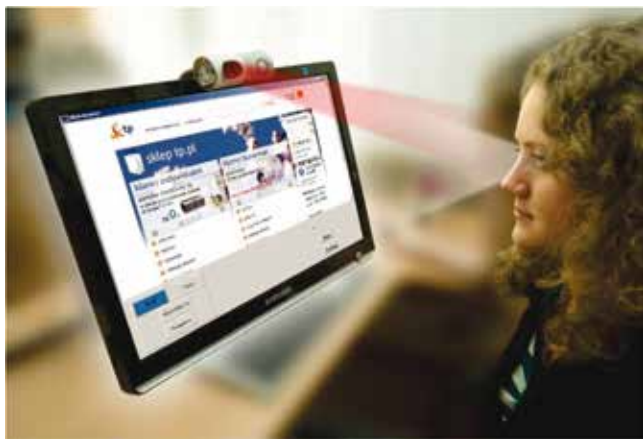
Przykład zastosowania interfejsu b-Link do sterowania przeglądarką
