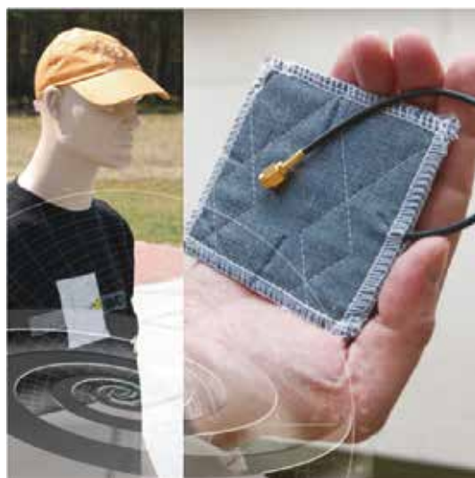
Antena tekstylna i jej zastosowanie jako elementu odzieży ochronnej
