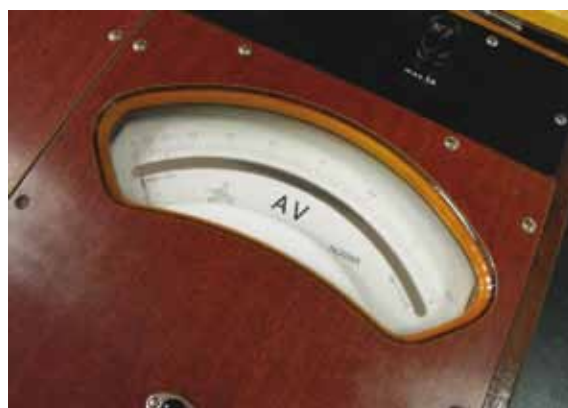
Fot. 16. Skala miernika z fotografii 15. Widoczna podziałka nierównomierna. Mechanizm elektrodynamiczny klasy 0,2, o poziomej pozycji pracy
