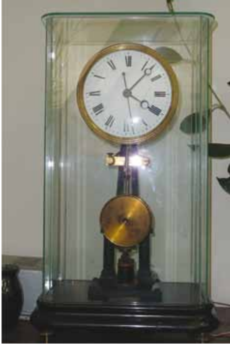
Fot. 7. Zegar konstrukcji Matthijasa HIPPA (Szwajcaria). Stosowany w charakterze zegara-matki, zasilającego sieć czasu w fabrykach i instytucjach – także na kolei. Błąd wskazań nie przekraczał 10 sekund na rok. Zbiory profesora Sawickiego z Politechniki Gdańskiej
