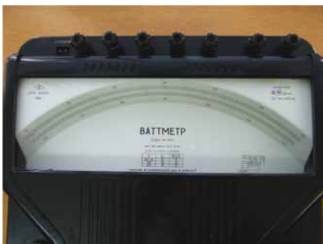
Fot. 3. Watomierz elektrodynamiczny klasy 0,2, z podziałką transwersalną i podwójną skalą o konstrukcji zbliżonej do miernika z fotografii 1. Zbiory Instytutu Systemów Inżynierii Elektrycznej Politechniki Łódzkiej
