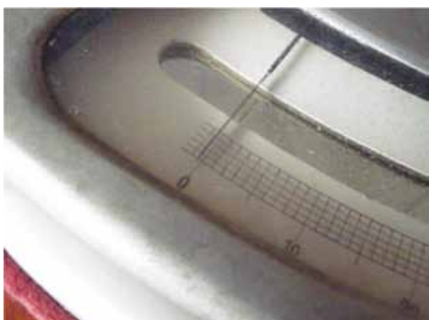
Fot. 14. Fragment podziałki transwersalnej woltomierza wzorcowego, z fotografii 11
