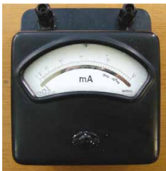
Fot. 17. Miliamperomierz prądu stałego i przemiennego z mechanizmem magnetoelektrycznym oraz termoelektrycznym przetwornikiem wartości skutecznej o zakresie częstotliwości 15 Hz ÷ 100 MHz. Zbiory Instytutu Systemów Inżynierii Elektrycznej Politechniki Łódzkiej
