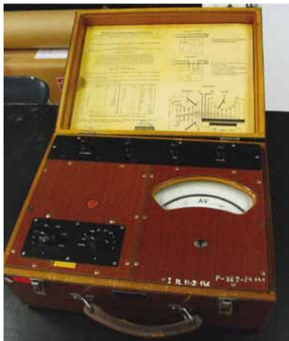
Fot. 15. Miernik kombinowany (amperomierz lub woltomierz). Zakres 1000 V lub 5 A. Zalegalizowany w roku 1962. Zbiory AGH
