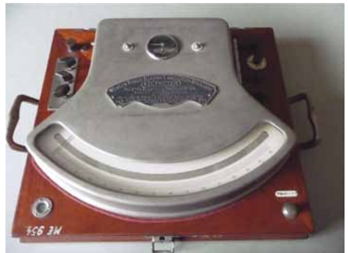
Fot. 11. Wzorcowy woltmierz magnetoelektryczny z możliwością zmiany zakresu, z podziałką transwersalną. Zalegalizowany w roku 1908. Zbiory profesora Jerzego Sawickiego z Politechniki Gdańskiej
