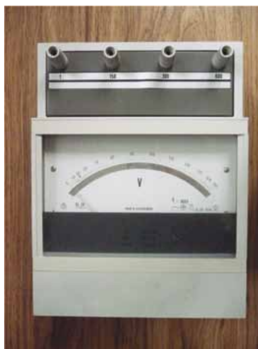
Fot. 6. Voltomierz elektrodynamiczny klasy 0,2, zakres pomiarowy 600 V. Zbiory profesora Jerzego Sawickiego z Politechniki Gdańskiej
