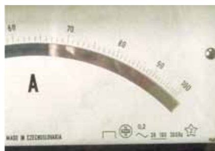
Fot. 5. Tabliczka znamionowa amperomierza z fotografii 4. Dla przypomnienia – pozycja pracy przyrządu pozioma, miernik o ustroju elektrodynamicznym, klasy 0,2, prądu przemiennego, zakres częstotliwości 30 \div 100 Hz, napięcie probiercze 2 kV
