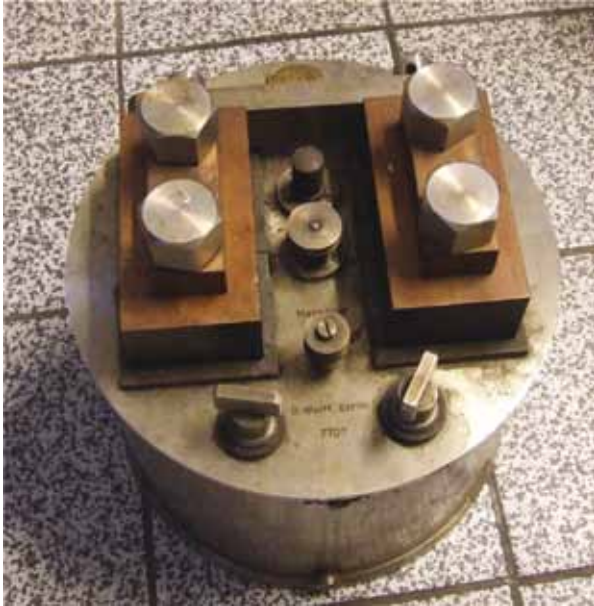
Fot. 18. Wieloprądowy bocznik precyzyjny o rezystancji 0,0001 \Omega z roku 1935. Produkcja Otto Wolff – Berlin. Zbiory profesora Zdzisława Nawrockiego z Politechniki Wrocławskiej
