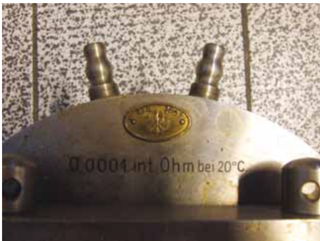
Fot. 19. Widoczny znak legalizacyjny wieloprądowego bocznika precyzyjnego z fotografii 18
