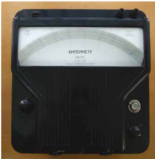
Fot. 1. Amperomierz elektrodynamiczny klasy 0,1, z podziałką transwersalną i podwójną skalą. Widoczne są dwa źródła światła dzięki którym każda skala była oświetlana indywidualną wskazówką świetlną. Zbiory Instytutu Systemów Inżynierii Elektrycznej Politechniki Łódzkiej
