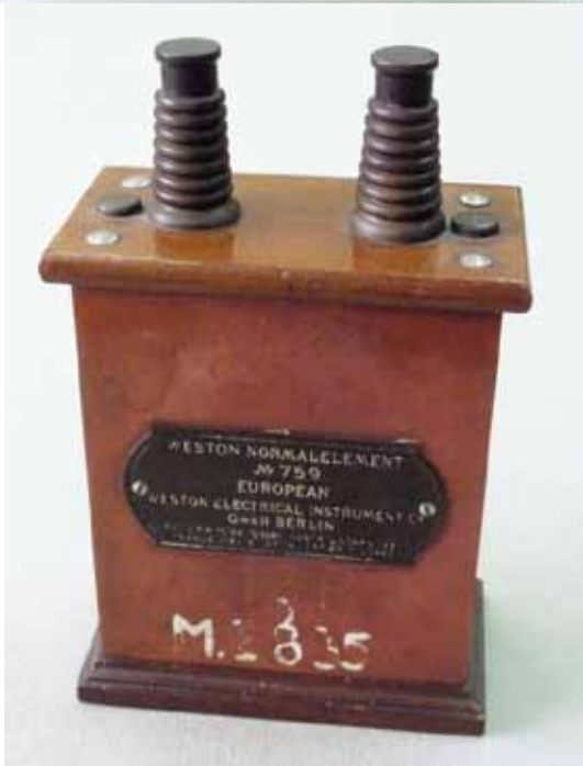
Fot. 12, 13. Wyposażenie woltomierza precyzyjnego z fotografii 11. Przelączalny rezystor dodatkowy oraz ogniwo wzorcowe. Zbiory profesora Sawickiego z Politechniki Gdańskiej
