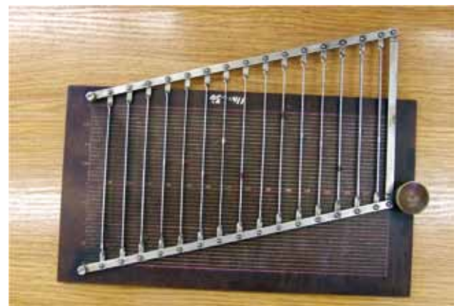
Fot. 21. Położenie prętów i wskaźników drabinki Krukowskiego przy wyznaczaniu poprawek dla drugiego zakresu pomiarowego dla wartości widocznych na fotografii 20
