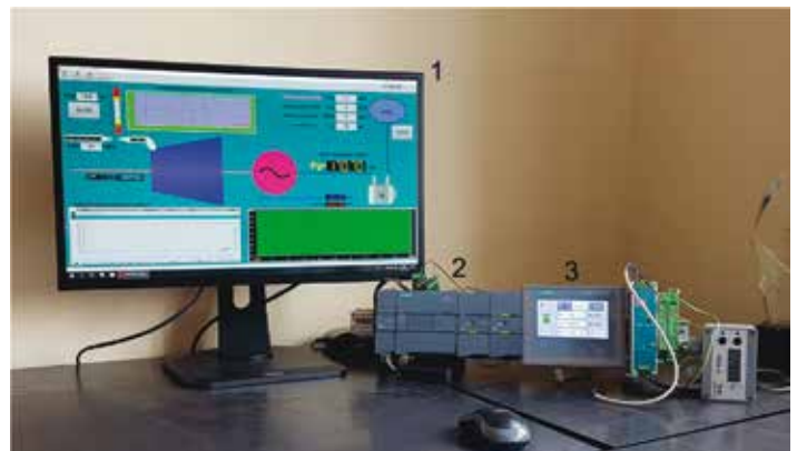
Rys. 4. Główne elementy symulatora UAR turbiny kondensacyjnej: 1 – wizualizacja SCADA na ekranie komputera PC; 2 – sterownik PLC z modułami WE/WY; 3 – panel sterujący HMI
