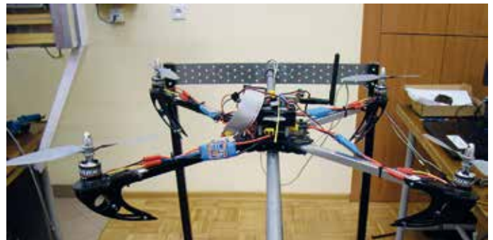
Rys. 2. Finalna postać konstrukcji kwadrokoptera wraz z zamontowanym układem sterującym, umieszczona na platformie testowej
