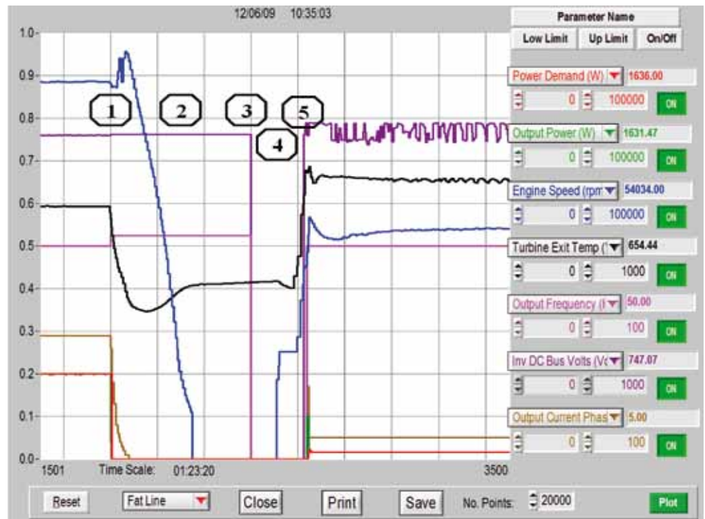
Rys. 19. Proces przejścia mikroturbiny do pracy wyspowej
