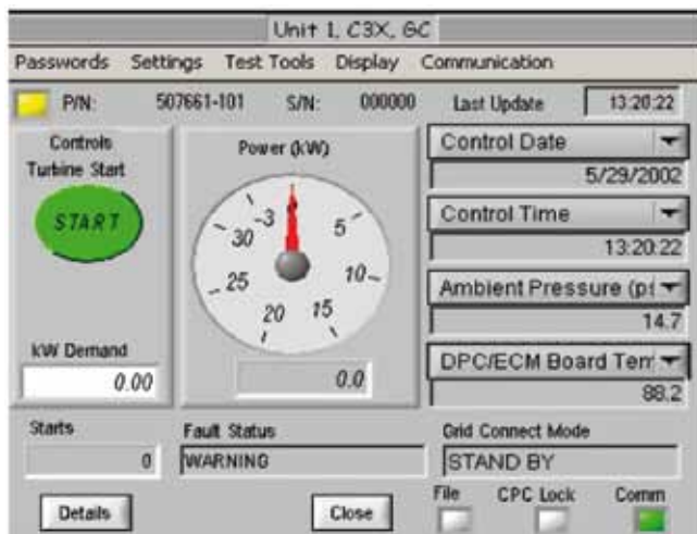
Rys. 13. Widok podstawowego ekranu programu CRMS sterującego pracą mikroturbiny
