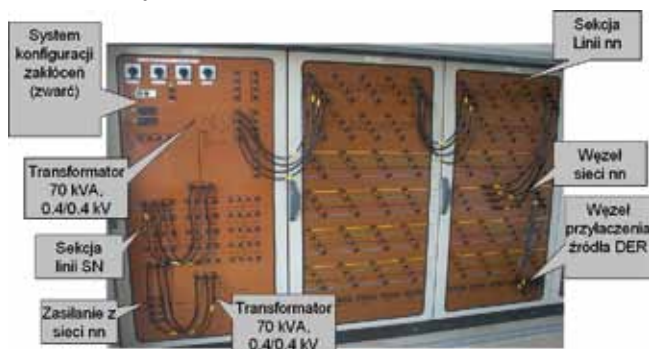
Rys. 3. Widok tablicy krosowej w laboratorium urządzeń generacji rozproszonej
