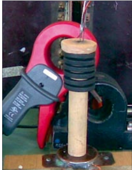
Rys. 4. Układ wzbudnik-próbka badawcza wsadu
