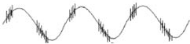
Rys. 1. Wzr w postaci impulsów na sinusoidzie napięcia roboczego
