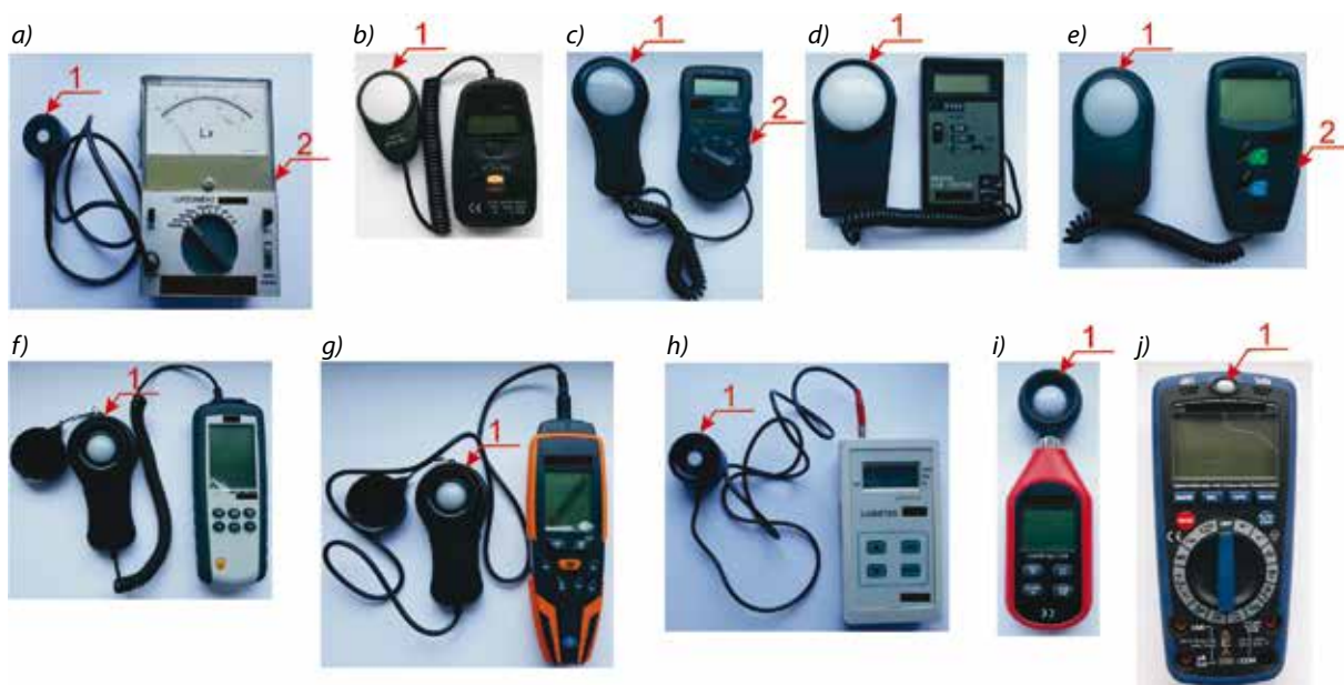
Rys. 1. Zdjęcia przykładowych luksomierzy: a) miernik analogowy, b) – j) mierniki cyfrowe, 1 – głowica fotometryczna, 2 – miernik prądu (rzadziej napięcia) fotoelektrycznego wyskalowany w luksach
