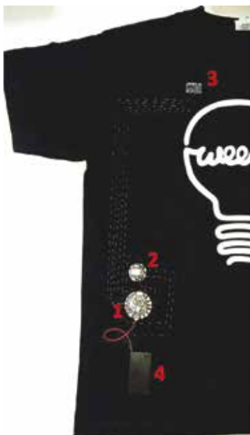
Rys. 1. Elektroniczny system tekstylny do lokalizacji wszyty w koszulkę
