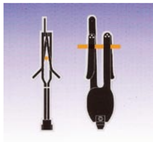
Rys. 3. Zacisk typu TULIPAN na uziemianym przewodzie
