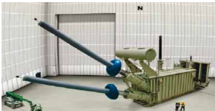
Rys. 10. Transformator do systemu \pm 800 kV DC, 6400 MW, 2071 km, jednofazowy, 550 kV AC, 816 kV DC, 321 MVA, firmy Siemens, według [8]
