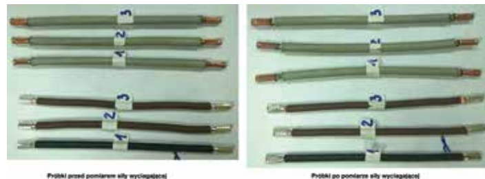
Rys. 6. Próbkę z końcówkami przed i po pomiarze siły wyciągającej
