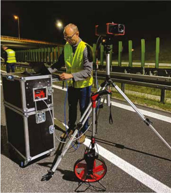
Rys. 1. System do matrycowego pomiaru luminancji na drodze GL Optacam 3.0 4K TEC
