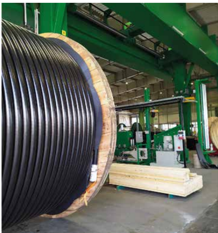
Stanowisko do przewijania kabli
