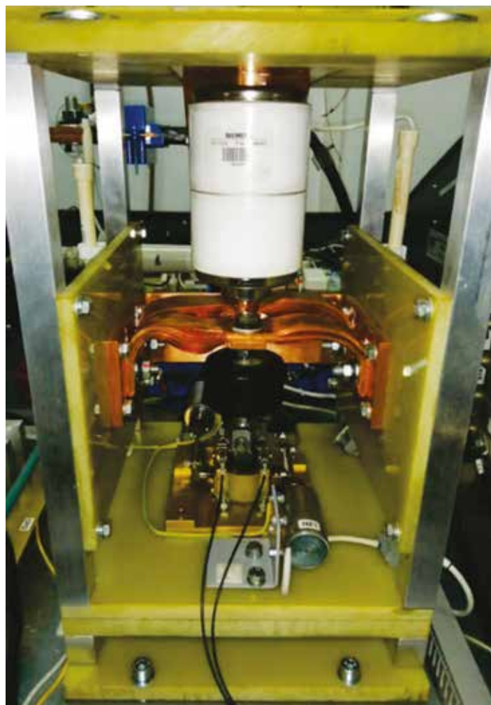
Próżniowy zespół wyłączający wyłącznika DCU-HM
