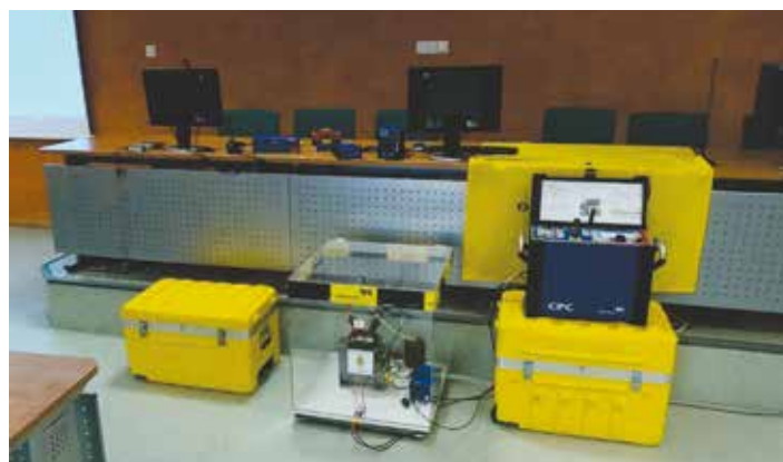
Widok na układ do symulacji wyładowań niepełnych prezentowany podczas seminarium
