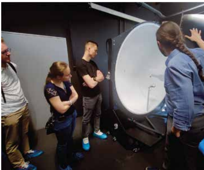
Prezentacja kuli całkującej współpracującej ze spektrometrią
