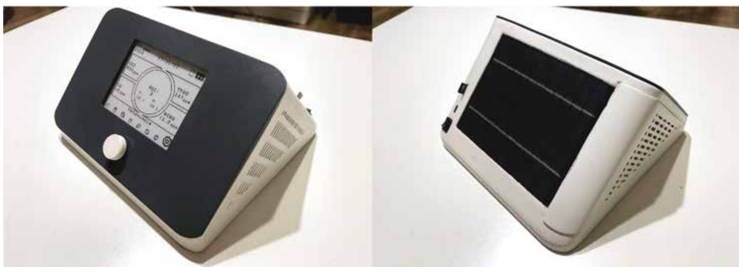
Zdjęcie urządzenia mierzącego parametry jakości powietrza stworzonego na potrzeby pracy magisterskiej
