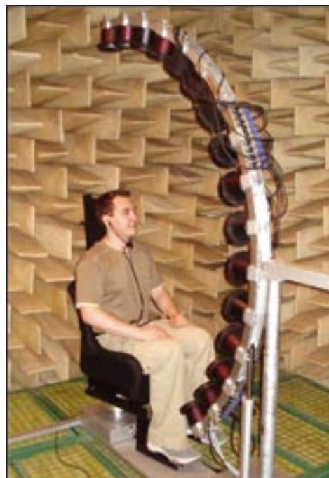
Rys. 5. Pomiar charakterystyk HRTF w komorze bezpogłosowej
