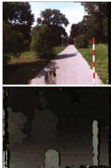
Rys. 3. Pojedyncza klatka pochodząca z jednej kamery (u góry) i wyliczona mapa odległości (u dołu); wzrastająca jasność punktów obrazu głębi oznacza zmniejszającą się odległość elementów sceny od obserwatora
