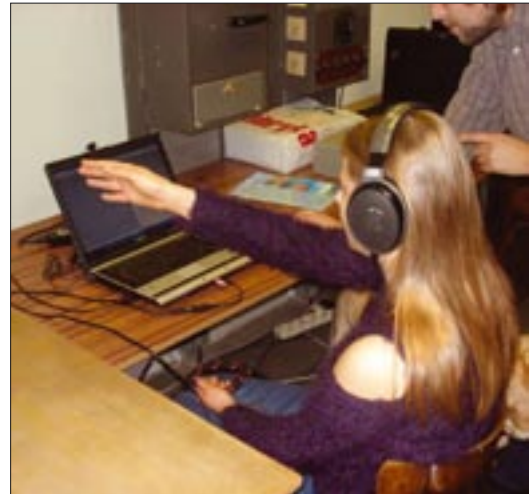
Rys. 7. Weryfikacja zmierzonych charakterystyk HRTF; osoba niewidoma prawidłowo wskazuje położenie wirtualnego źródła dźwięku
