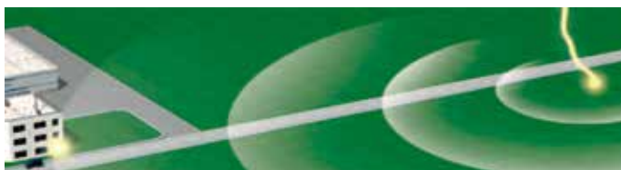
Rys. 2.3. Indukowanie przepięć przez pobliskie uderzenie piorunu [13]
