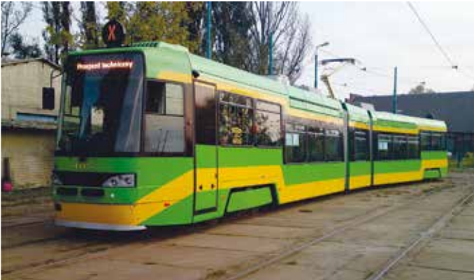
Rys. 2. Tramwaj Tatra RT6N1 na krańcówce w Poznaniu, (wrzesień 2011), w którym we współpracy z Zakładem Elektroniki Przemysłowej ENIKA w Łodzi zainstalowano prototypowe napędy asynchroniczne z wektorowym sterowaniem pulsacją poślizgu silników zasilanych nadal z indywidualnych falowników napięcia, ale z możliwością znacznego obniżenia ich częstotliwości pracy
