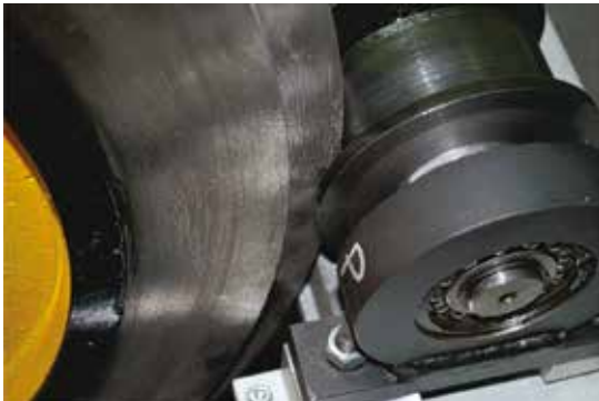
Rys. 16. Podtoczenia w obu kołach masowych stanowiska, które pozwalają zróżnicować stan współpracy danego kółka napędzanego przez silnik elektryczny ze współpracującym z nim kołem masowym: a) sytuacja, gdy brzeg kółka porusza się po obrzeżu koła masowego zamachowego, b) sytuacja, gdy kółko i koło masowe współpracują ze sobą normalnie, tj. stykając się walcowymi powierzchniami roboczymi
