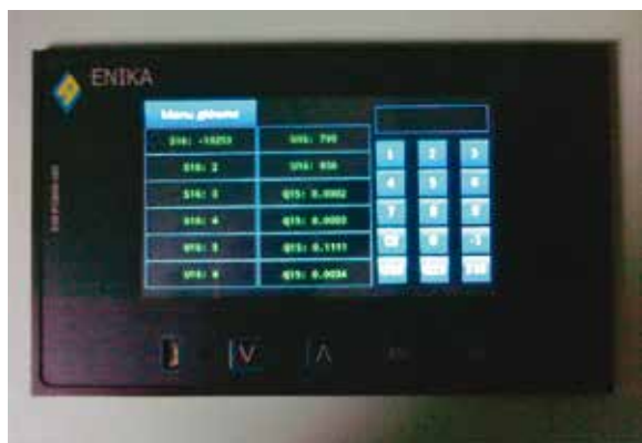
Rys. 14. Ekran z danymi konfiguracyjnymi wysyłanymi do sterownika falownika
