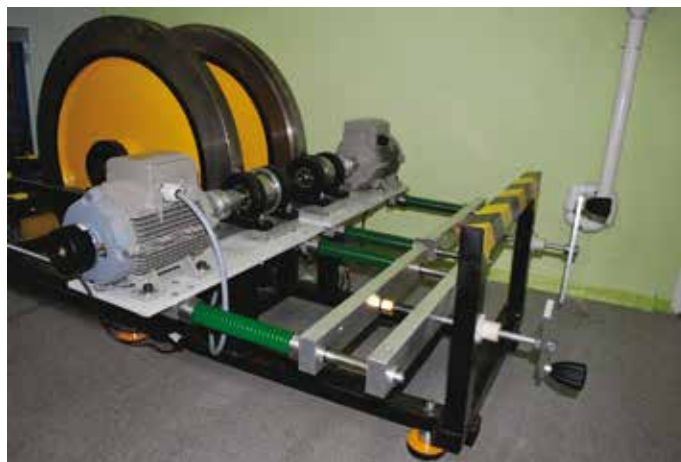
Rys. 15. Stanowisko do odwzorowywania stanów nieustalonych napędu asynchronicznego
