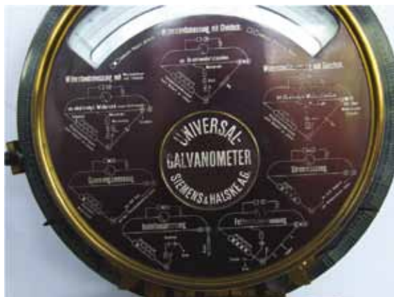
Fot. 5. Galwanometr uniwersalny produkcji Siemens & Halske z 1897 r. wraz z układami pracy (zbiory Instytutu Systemów Inżynierii Elektrycznej)
