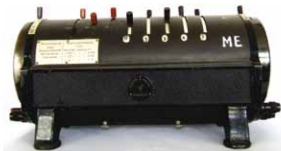
Fot. 11. Kompensator napięcia stałego typu Feussnera pozwalający na bezpośredni „cyfrowy” odczyt napięcia. W układzie bezpośrednim zakres napięcia 1,2 V z dzielnikiem napięcia 1200V, (zbiory Instytutu Systemów Inżynierii Elektrycznej)
