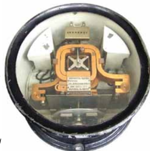
Fot. 3. Najstarszy elektromechaniczny licznik energii elektrycznej z roku 1899 ze zbiorów Instytutu Systemów Inżynierii Elektrycznej, produkcji rosyjskiej. Napięcie 600 V, prąd 1000 A.
