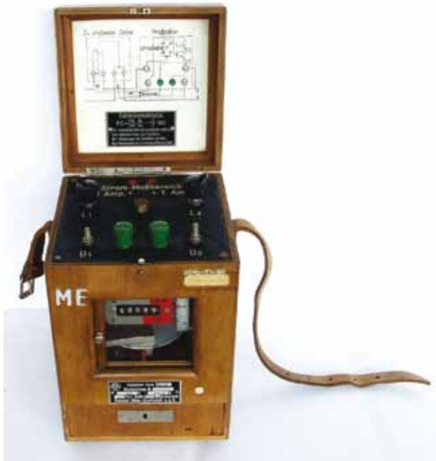
Fot. 4. Wzorcowy licznik indukcyjny energii elektrycznej ze zbiorów Instytutu Systemów Inżynierii Elektrycznej. Napięcie 220 V, prąd 1 i 5 A
