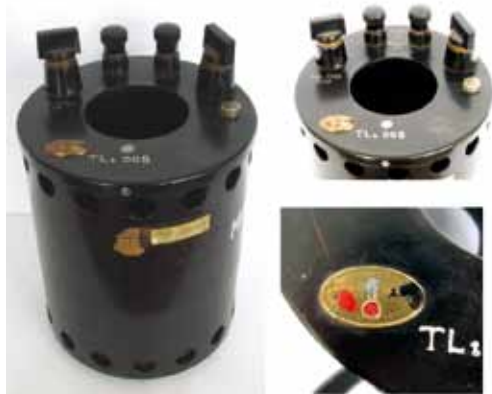
Fot. 8. Wzorcowy rezystor stały z roku 1936 produkcji Siemens & Halske. Widoczny znak legalizacji „Urzędu Miar III Rzeszy” (zbiory Instytutu Systemów Inżynierii Elektrycznej)
