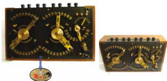
Fot. 10. Kompensator napięcia w układzie Rapsa [4]. Współpracując z przedstawionym wcześniej rezystorem stałym umożliwił zastosowanie jako kompensatora do pomiaru prądu. Na obudowie jest widoczna pozostałość po znaku legalizacji „Urzędu Miar III Rzeszy” (zbiory Instytutu Systemów Inżynierii Elektrycznej).
