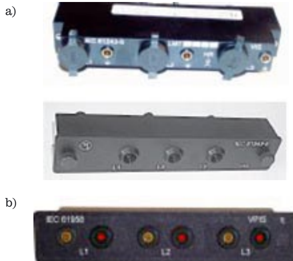
Rys. 1. Wskaźniki napięcia stosowane w rozdzielnicach pierścieniowych SafeRing oraz SafePlus firmy ABB: a) wg normy IEC 61243-5 – typ VDS – strona wtórna dzielnika wraz z gniazdam testowymi oraz moduł wskaźnika, który można umieścić na stałe w gniazdach, b) wg normy IEC 61958 – typ VPIS
