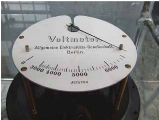
Fot. 18, 19. Woltmierz elektrostatyczny wysokiego napięcia produkcji niemieckiej
