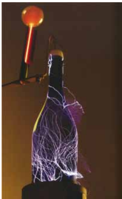
Fot. 35. Wystarczy podłączyć napięcie 40 kV, a iskry rozchodzą się po powierzchni szklanej butelki od szampana.
