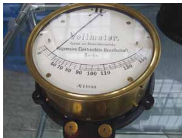
Fot. 17. Voltmierz napięcia przemiennego, wykonany według systemu polskiego wynalazcy Michała Dolivo-Dobrowolskiego
