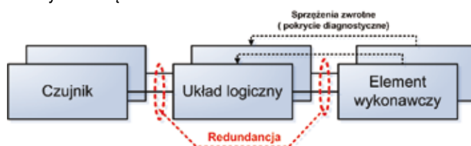
Rys. 2. Typowa struktura układu bezpieczeństwa
