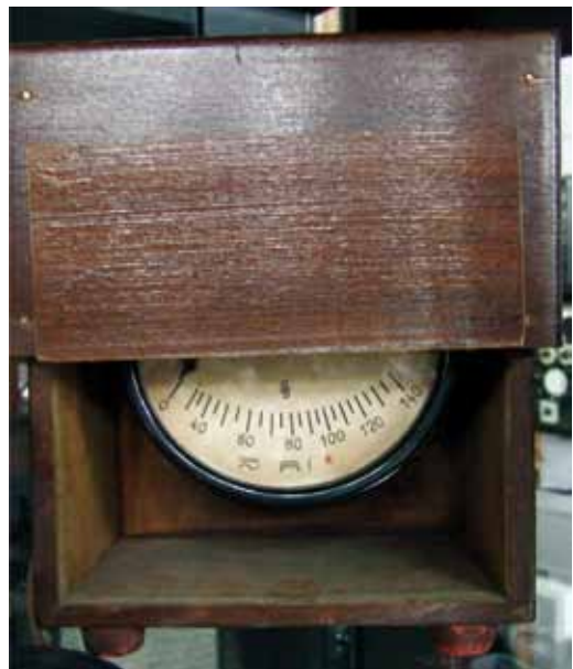
Fot. 23. Woltmierz tablicowy, przerobiony na przenośny przez telefonistę, który używał go od czasu robót przymusowych w III Rzeszy
