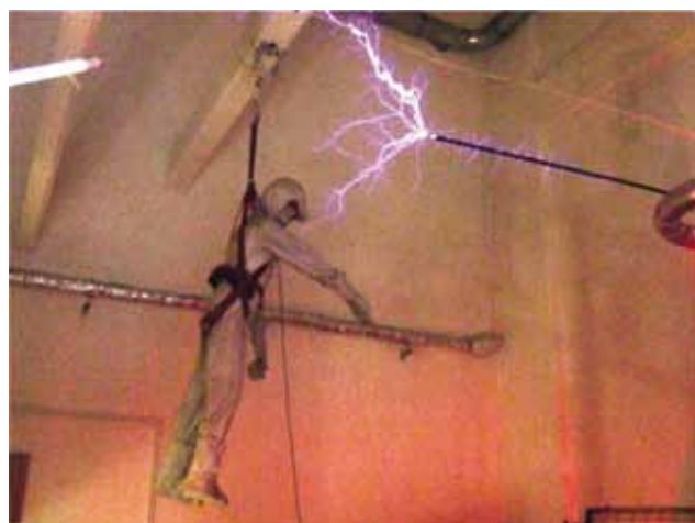
Fot. 37. Kombinezon do prac pod napięciem ponad sto tysięcy woltów opatentowany przez Bogumiła Dudka. Tajemnicą kombinezonu jest tkanina zawierająca posrebrzane druciki tworzące swoistą klatkę Faradaya
