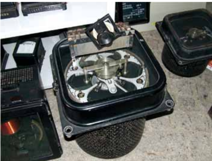
Fot. 31. Regulator napięcia generatora BBC oraz zatablicowy rezystor regulacyjny
