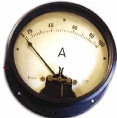
Fot. 22. Amperomierz bezpośredniego pomiaru z elektrowni wodnej w Rajczy
