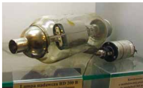
Fot. 39. Lampa nadawcza RD200B i kondensator o modulowanej pojemności z nadajnika w Radzionkowie, który zakłócał stację radiową Wolna Europa
