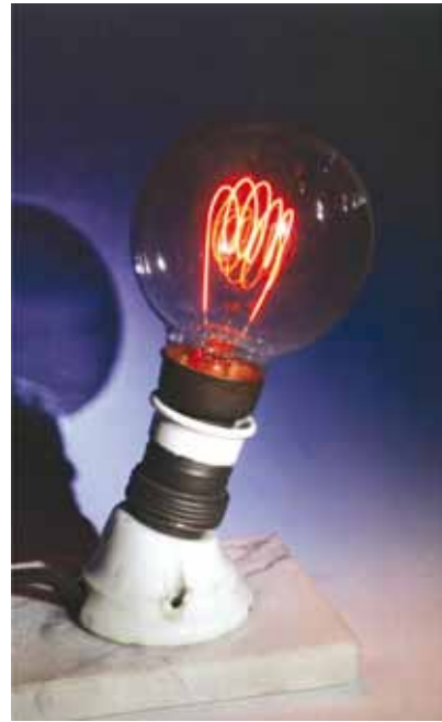
Fot. 32. Żarówka „Edisona” – tworzące żarnik włókno pochodzi z bambusa. Blisko 100-letnia angielska żarówka została zakupiona na targu staroci w Zimbabwe i po wielu perypetiach trafiła do polskiego muzeum techniki
