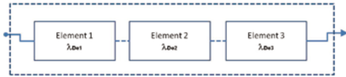
Rys. 3. Architektura A podsystemu realizującego funkcję bezpieczeństwa wg normy PN-EN 62061
