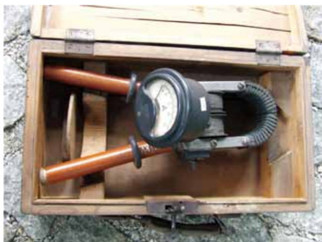
Fot. 27. Cęgi pomiarowe rodzimej produkcji zakładów Szpotańskiego
