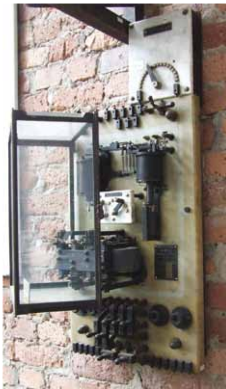
Fot. 8. Elektromechaniczny regulator napięcia wzbudzenia AEG TIRRIK SCHNELLREGLER typ TAF4-8
