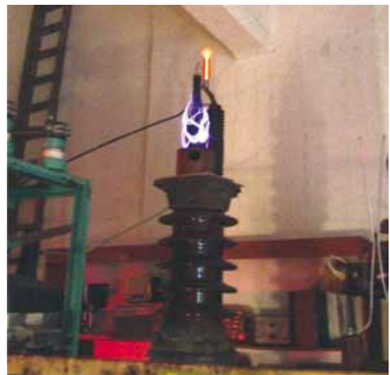
Fot. 34. Stanowisko do prezentacji wyładowań powierzchniowych
