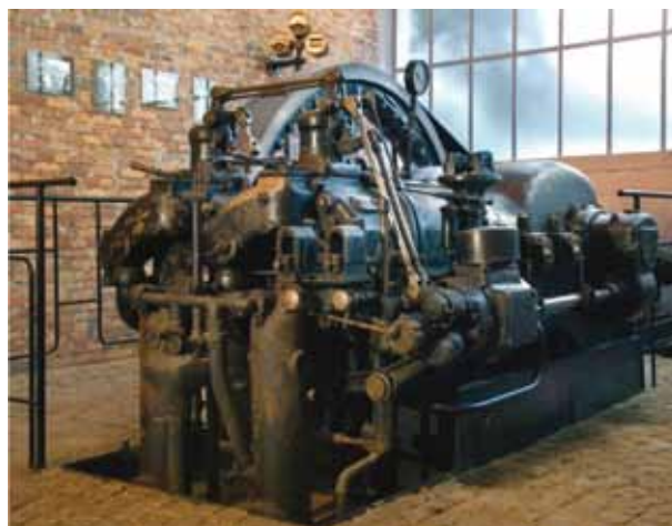
Fot. 9. Agregat na „scheiße gas”, czyli ekologiczny agregat prądotwórczy z lat 1937 – 1938
