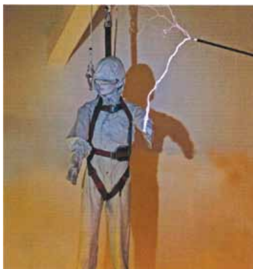
Fot. 36. Wyładowanie iskrowe między elektrodą a „człowiekiem” chronionym specjalnym kombinezonom produkcji polskiej
