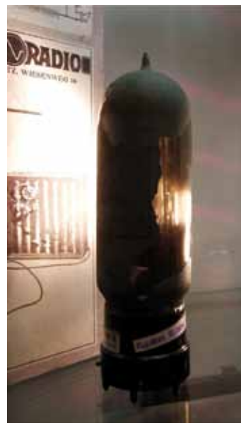
Fot. 38. Pierwszy na świecie układ scalony – lampa radiowa z roku 1927. Bańka lampy zawiera elementy stanowiące kompletny odbiornik radiowy zasilany bateryjnie 3 triody, 4 rezystory, 2 kondensatory
