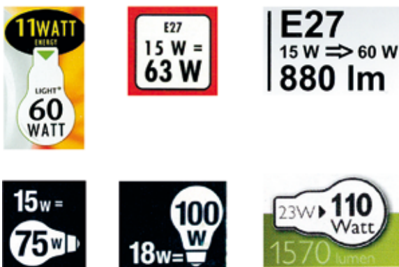
Rys. 2. Przykłady cechowania lamp dwoma wartościami mocy przez różnych producentów
