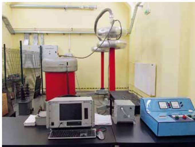
Wyspecjalizowany, komputerowy układ do pomiaru wyładowań niezupełnych w urządzeniach wysokiego napięcia
