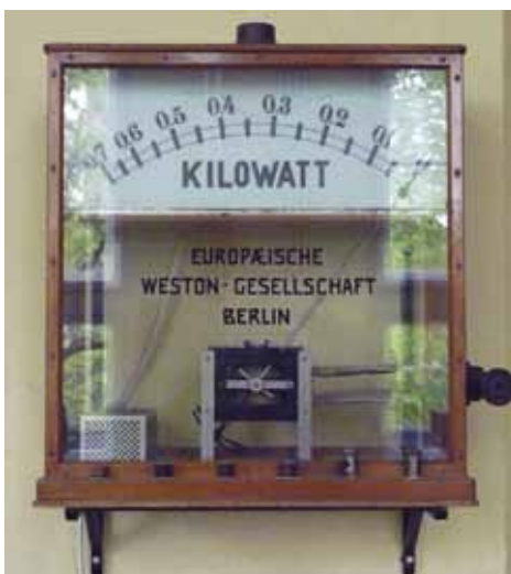
Fot. 1. Watomierz indukcyjny typu bębnowego (Ferraris). Mechanizmy pomiarowe amperomierzy, woltmierz i watomierzy indukcyjnych są do siebie podobne. Tłumienie organu ruchomego (aluminium bębna) powstaje przez oddziaływanie magnesu trwałego na prądy wirowe indukowane przez strumień napięciowy (zbiory profesora Sawickiego z Politechniki Gdańskiej)
