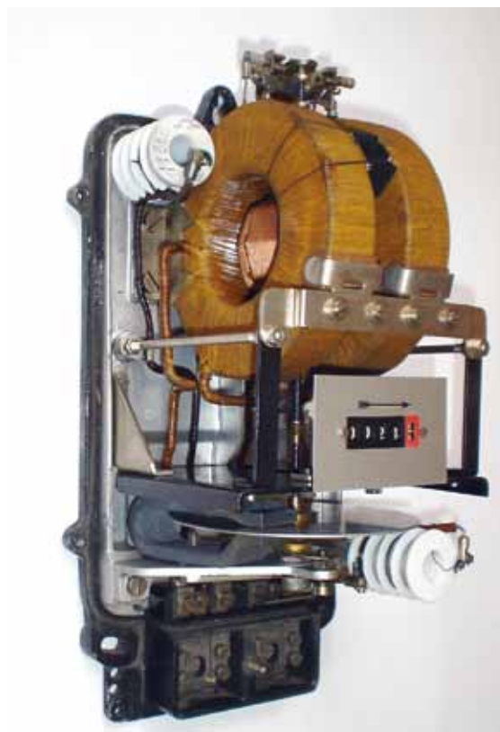
Fot. 16. Licznik elektrodynamiczny (fot. 15.), po zdjęciu obudowy. Licznik produkowany w latach trzydziestych XX wieku, ilość zainstalowanych egzemplarzy – rzędu kilku tysięcy sztuk. Zewnętrzne dużych wymiarów są cewki prądowe, wewnątrz widoczna jest okrągła cewka napięciowa na osi z osadzoną aluminiową tarczą hamującą [5]
