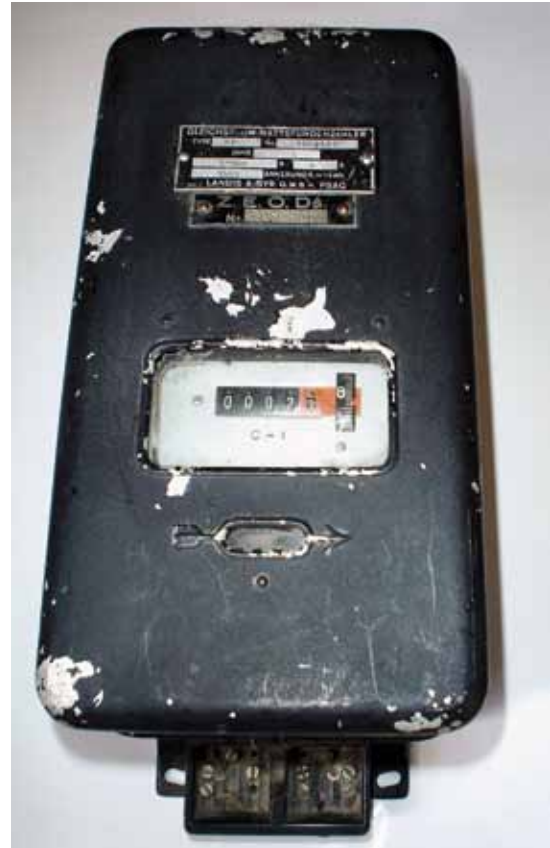
Fot. 10. Licznik energii prądu stałego, elektrodynamiczny (motorowy), typ BD na napięcia 2 x 220 V, prąd 5 A. Producent LANDIS & GYR GMBH, początek XX wieku (zbiór autorski dr inż. Romualda Nowakowskiego z Politechniki Szczecińskiej)
