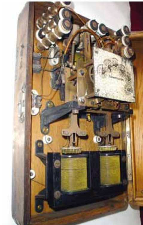
Fot. 20. Licznik energii z fotografii 19 po demontażu obudowy. Widoczne są dwa jednakowe wahadła, na końcach których są umocowane cewki napięciowe, poniżej cewki prądowe
