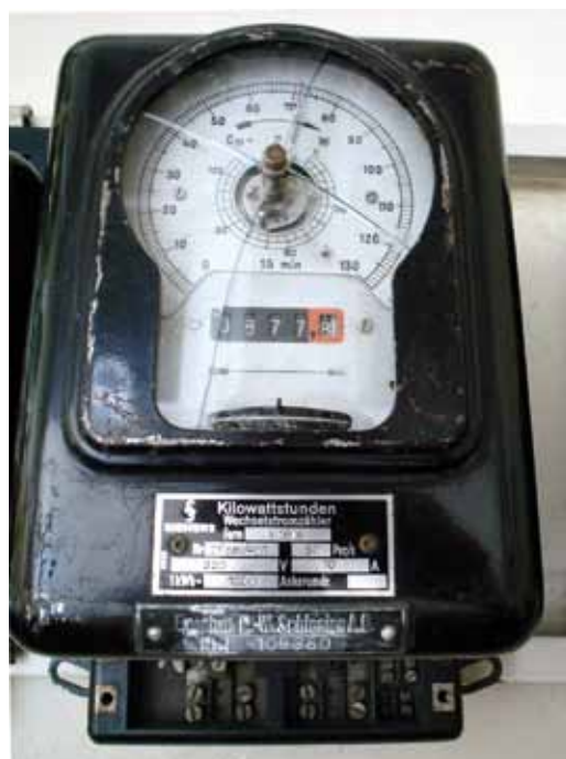
Fot. 22. Licznik energii prądu przemiennego jednofazowego (indukcyjny) ze wskaźnikiem mocy maksymalnej, typ W16m, Napięcie 220 V prąd 10 A. Producent SIEMENS, rok 1935 (kolekcja doktora Nowakowskiego)
