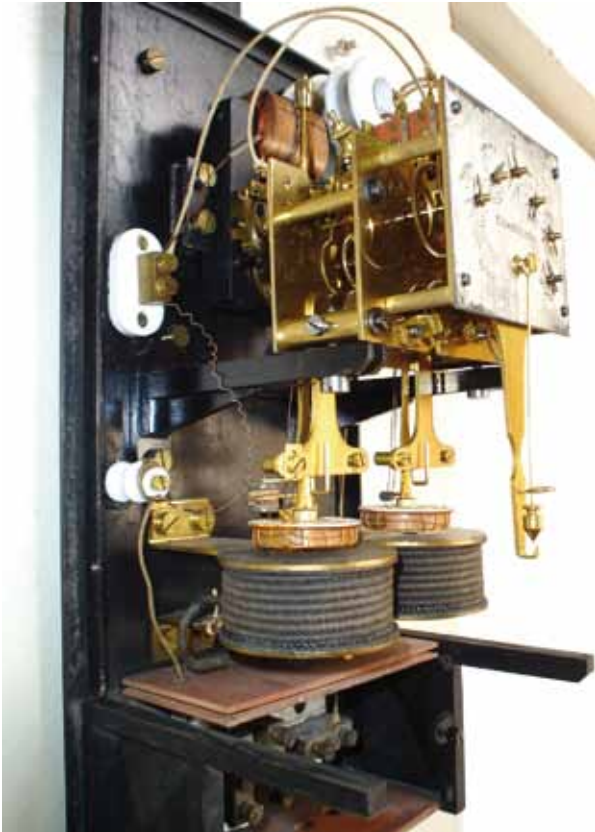
Fot. 8. Licznik typu wahadlowego z fotografii 7 – struktura wewnętrzna. Taki licznik mógł być zainstalowany tylko u znaczącego odbiorcy, takiego jak lokal handlowy, bank czy willa zamożnego mieszkańca wielkiego miasta. Widoczne jest liczydło wskazówkowe, naciąg elektryczny napędu i dwa jednakowe wahadła, na końcach których są umocowane cewki napięciowe, poniżej cewki prądowe [5]
