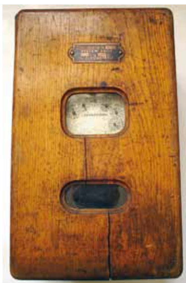
Fot. 19. Licznik energii prądu stałego, elektrodynamiczny, dwuwahadłowy. Egzemplarz w wykonaniu przenośnym, obudowa drewniana, stosowany jako wzorcowy w instalacjach prądu stałego (kolekcja doktora Nowakowskiego)
