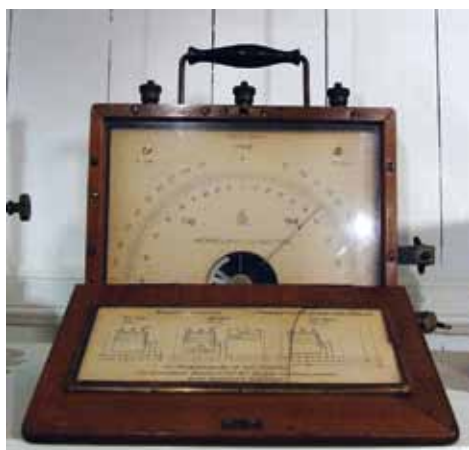
Fot. 5. Ferrodynamiczny miernik współczynnika mocy ( \cos \varphi ). Cewka prądowa jest nieruchoma, a ruchome są cewki napięciowe mechanicznie ze sobą sprzężone, prąd jest doprowadzony do tych cewek za pomocą elastycznych tasiemek (bezmomentowych). Tłumienie organu ruchomego powstaje przez oddziaływanie magnesu trwałego na prądy indukowane w aluminiowej tarczy poruszającej się między jego biegunami. Produkcja Hartmann & Braun – Frankfurt, rok 1924. Zbiory Muzeum Politechniki Wrocławskiej
