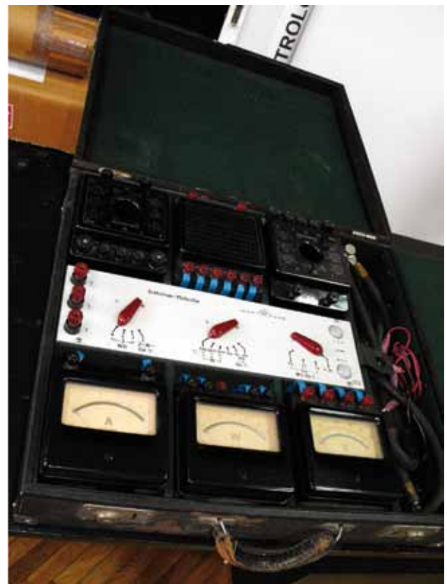
Fot. 3. Walizka pomiarowa do wyznaczania mocy odbiorników trójfazowych. Produkcja Goerz Austria, pierwsza połowa XX w. Zbiory AGH Kraków
