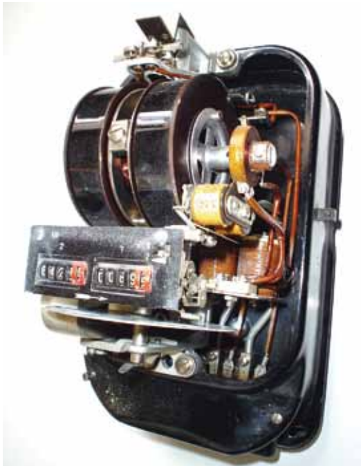
Fot. 18. Wnętrze licznika z fotografii 17. Zwrócić uwagę należy na zwartą konstrukcję cewek prądowych, cewki kompensacyjne oraz widoczny przełącznik taryfowy liczydeł. Licznik był własnością elektrowni we Wrocławiu (Breslau w okresie okupacji niemieckiej) [5]
