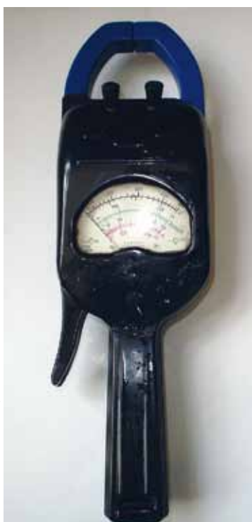
Fot. 5. Ferrodynamiczny miernik współczynnika mocy ( \cos \varphi ). Cewka prądowa jest nieruchoma, a ruchome są cewki napięciowe mechanicznie ze sobą sprzężone, prąd jest doprowadzony do tych cewek za pomocą elastycznych tasiemek (bezmomentowych). Tłumienie organu ruchomego powstaje przez oddziaływanie magnesu trwałego na prądy indukowane w aluminiowej tarczy poruszającej się między jego biegunami. Produkcja Hartmann & Braun – Frankfurt, rok 1924. Zbiory Muzeum Politechniki Wrocławskiej
