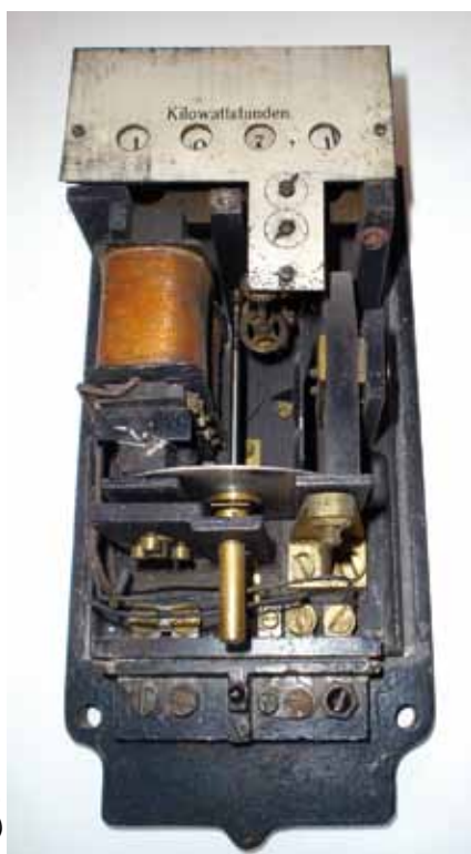
Fot. 12. Licznik elektrodynamiczny energii prądu stałego z fotografii 10, widoczne klasyczne duże cewki prądowe i okrągła cewka napięciowa. Licznik przeznaczony dla odbiorców komunalnych w latach trzydziestych XX wieku [5]
