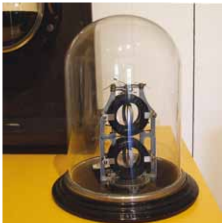
Fot. 4. Watomierz elektrodynamiczny-astacyjny. Produkcja Weston Instrument – Berlin, Niemcy rok 1920. Zbiory Muzeum Politechniki Wrocławskiej
