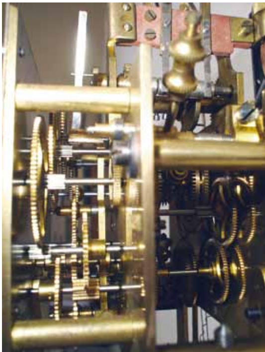
Fot. 9. Licznik typu wahadlowego z fotografii 7, konstrukcja liczydła. Wykonanie mechanizmu zliczającego wymagało zegarmistrzowskiej precyzji i umiejętności. Licznik wahadłowy stanowił bowiem połączenie konstrukcji miernika elektrodynamicznego i mechanizmu zegarowego. Metalowe części były oksydowane, a szklana obudowa przystosowana była do plombowania przez dostawcę energii elektrycznej [5]
