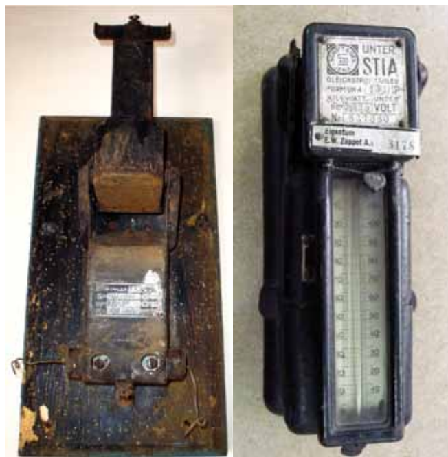
Fot. 25. Elektrolityczny licznik energii pokazany w pozycji zerowania wskazania [5]
