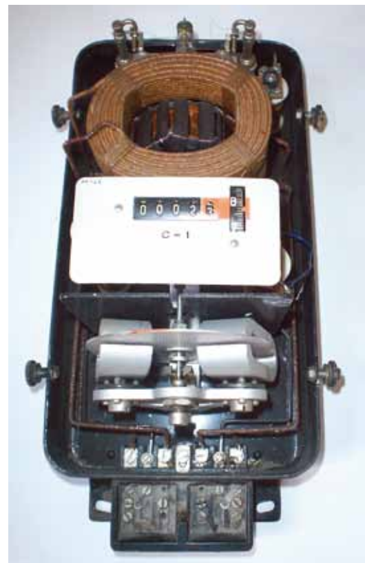
Fot. 11. Licznik energii prądu stałego, elektrodynamiczny (motorowy), typ BD z fotografii 10, po zdemontowaniu obudowy. Widoczna ruchoma cewka napięciowa i magnesy hamujące
