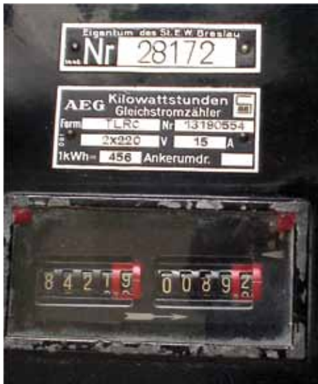
Fot. 17. Licznik energii prądu stałego, elektrodynamiczny (motorowy), AEG, dwutaryfowy na napięcie 2 x 220 V, prąd 15 A. Legalizacja typu cyfrą 88. Licznik z tabliczką własności „Breslau” nr 28172
