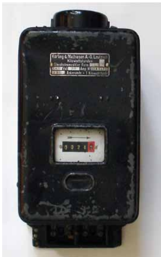
Fot. 15. Licznik energii prądu stałego, elektrodynamiczny (motorowy). Napięcie 440 V, prąd znamionowy 20 A. Korting&Mathiesen AG LEUTZSCH, początek XX wieku (zbiór autorski dr inż. Romualda Nowakowskiego z Politechniki Szczecińskiej)
