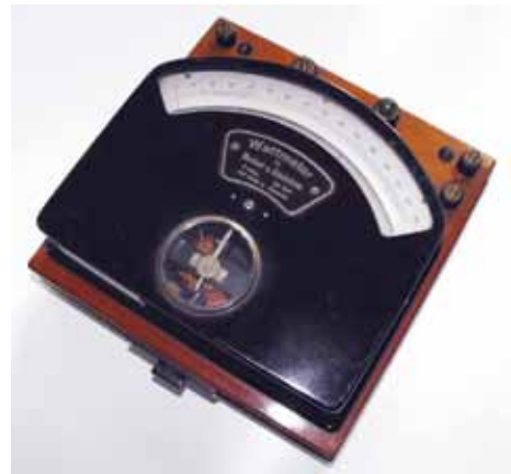
Fot. 2. Watomierz elektrodynamiczny. Ruchoma cewka napięciowa jest umieszczona wewnątrz nieruchomej prądowej. Produkcja Siemens & Halske z 1907 r. Zbiory AGH Kraków
