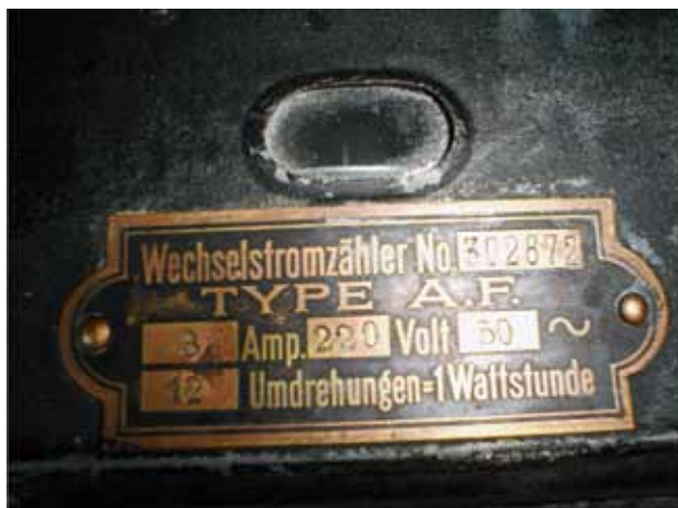
Fot. 14. Tabliczka znamionowa licznika energii prądu przemiennego z fotografii 12. Napięcie 220 V prąd 3 A. Należy zwrócić uwagę na mały zakres rejestracji – liczydło 3-cyfrowe i mały prąd znamionowy
