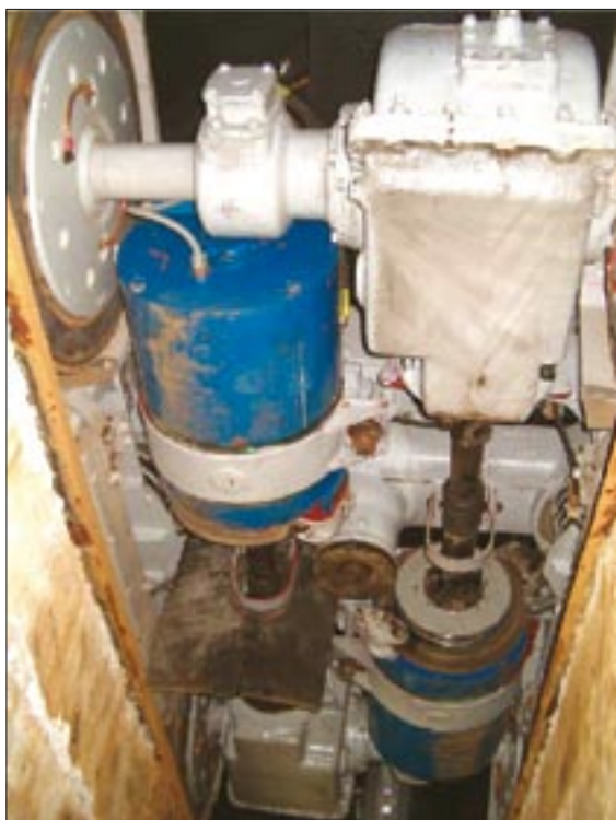
Rys. 8. Dwa silniki indukcyjne typu STDa200L4 zamontowane na miejscu silników prądu stałego w wózku modernizowanego tramwaju typu 805N
