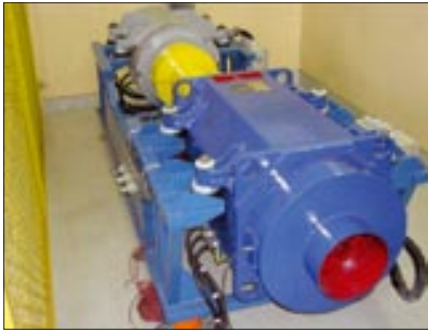
Rys. 13. Silnik indukcyjny STDA 200 6B o mocy 165 kW podczas prób na hamowni (Lublin 2005 r.)
