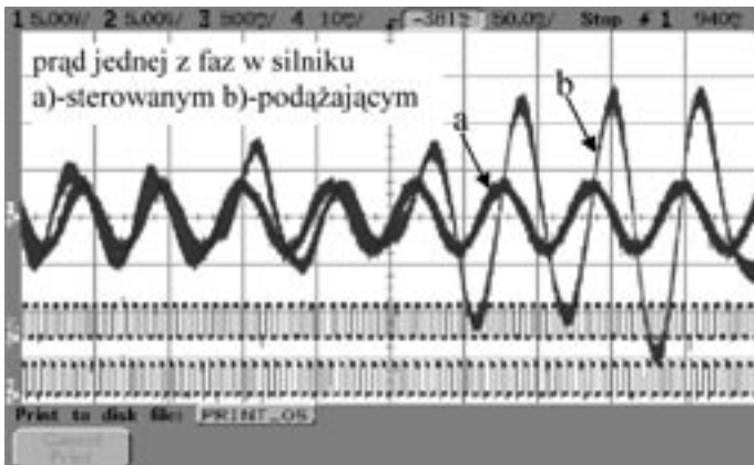
Rys. 4. Przebiegi prądu w jednej z faz silnika podczas przejazdu przez zwrotnicę
