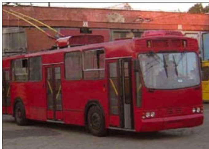
Rys. 12. Zmodernizowany trolejbus PR 110E z napędem asynchronicznym (Lublin 2006 r.)
