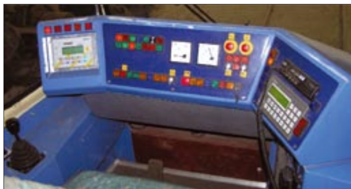
Rys. 11. Zmodernizowany pulpit motorniczego
