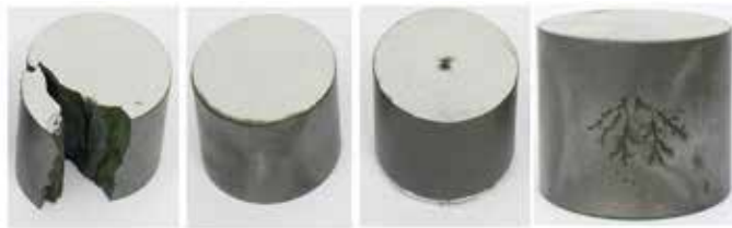
Rys. 10.12. Zniszczone w czasie próby udarowej (90/200 us) płytki warystorowe [9]
