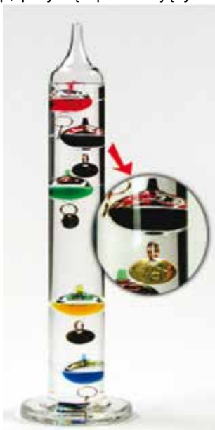
Rys. 10. Termoskop według zasady Galileusza [1]
