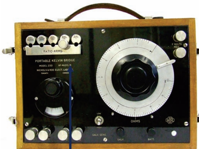
Fot. 7. Laboratoryjny Mostek Thomsona –wersja współczesna, sprzężenie mechaniczne rezystorów R1-R3 uzyskuje się przez umieszczenie ich dekad na jednej osi. Poniżej oryginalny schemat aplikacyjny rok 1956
