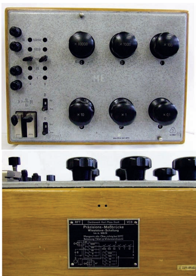
Fot. 11. Laboracyjny Mostek Wheatstone'a – wersja współczesna oraz oryginalny schemat aplikacyjny umieszczany na obudowie przyrządu rok 1956, RFT
