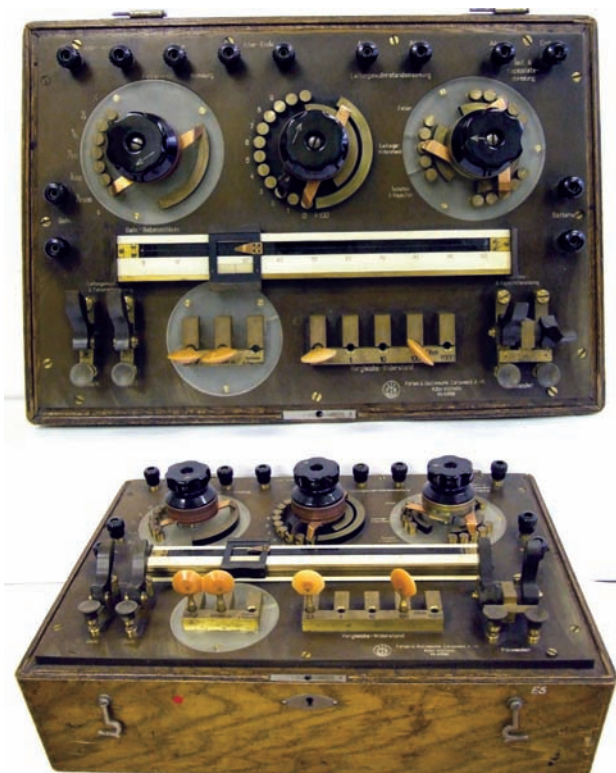
Fot. 15. Mostek do lokalizacji uszkodzeń kabli w układzie Varley'a (Felten & Guillaume)
