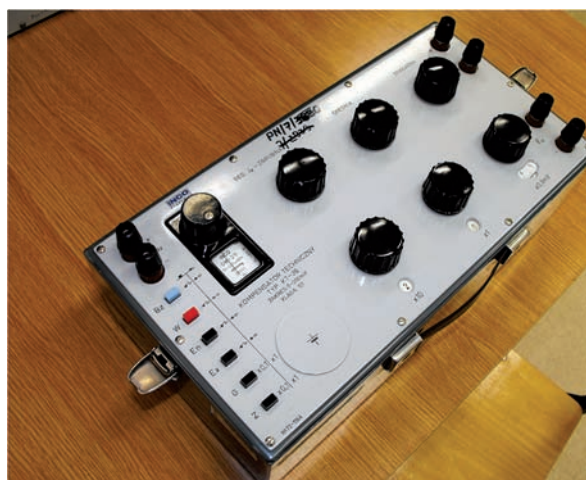
Fot. 4. Kompensator Techniczny w układzie Feusnera do sprawdzania ogniw termoelektrycznych rok produkcji 1969
