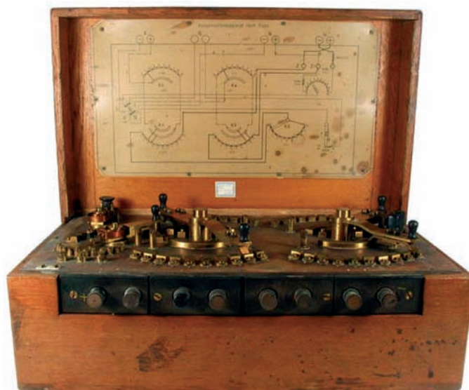
Fot. 2. Kompensator napięcia w układzie Rapsa firmy Siemens und Halske
