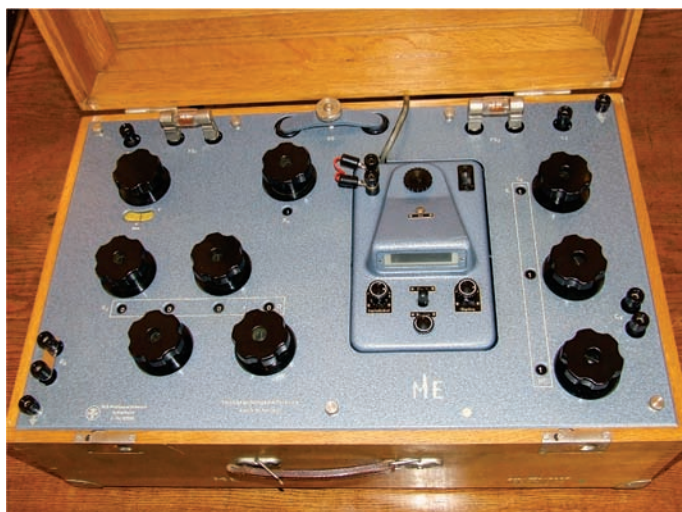
Fot. 12. Wysokonapięciowy, Techniczny Mostek Scheringa do pomiaru pojemności produkcji VEB
