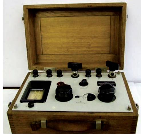
Fot. 16. Mostek do lokalizacji uszkodzenia linii kablowej produkcja Goerz – Wien
