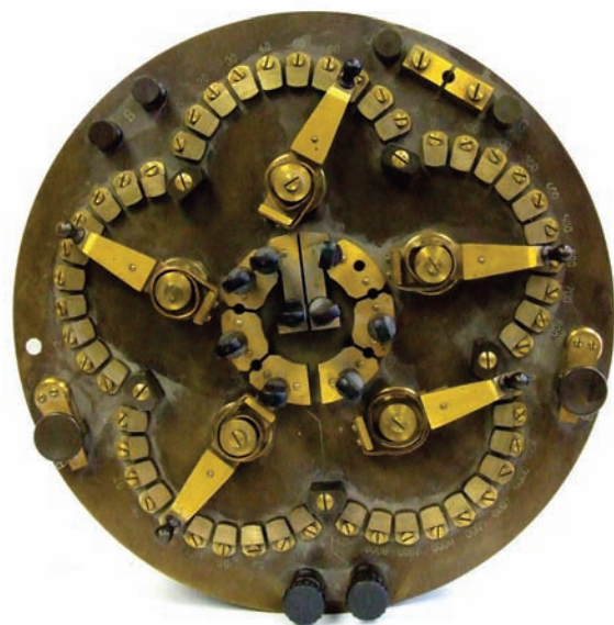
Fot. 9. Mostek Wheatstone'a w wykonaniu laboratoryjnym. To także dzieło sztuki mechaniki precyzyjnej i estetyki – Siemens und Halske rok 1920
