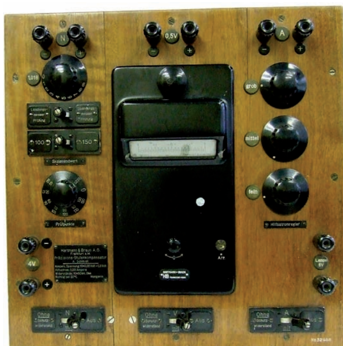
Fot. 1. Kompensator Schmidta do sprawdzania dokładności przyrządów wskazówkowych z możliwością bezpośredniego wyznaczenia poprawki produkcji Hartmann und Braun
