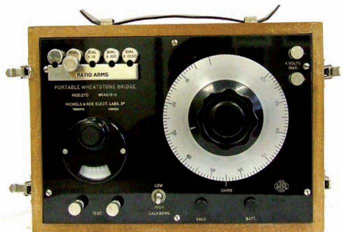
Fot. 10. Techniczny Mostek Wheatstone'a to także dbałość o precyzję wykonania, produkcja Nichols and Roe Elect. Labs(Kanada)
