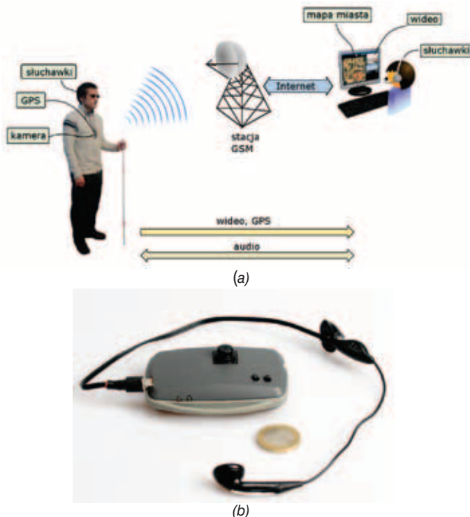
Rys. 10. System telenawigacji dla osoby niewidomej (a) oraz widok terminala mobilnego osoby niewidomej (wyposażonego w miniaturową kamerę, odbiornik GPS, zestaw słuchawkowy i moduł Bluetooth)
