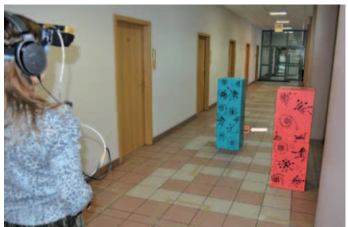
Rys. 8. Testy systemu do „dźwiękowego obrazowania otoczenia”; kolorowe kartonowe pudełka pełnią rolę przeszkód; zadaniem niewidomego uczestnika testu jest bezkolizyjne przejście do miejsca znajdującego się za niebieskim kartonem (zaznaczonym białą strzałką)
