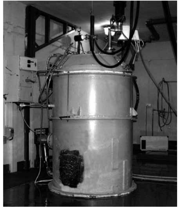
Rys. 4. Widok pieca do wtryskiwania odpadów (Katedra Aparatów Elektrycznych PŁ)
